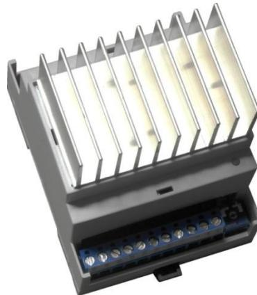
Na čelním panelu je umístěn chladič triaku a kontrolka provozu. LED kontrolka signalizuje stav, ve kterém se regulátor nachází. V běžném provozním stavu kontrolka svítí trvale. Změnou otáček (úhlu otevření) se mění intenzita svitu kontrolky. Blikání signalizuje činnost havarijního vstupu/tepelné přetížení.
