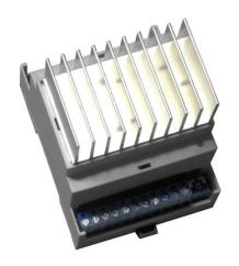
Na čelním panelu je umístěn chladič triaku a kontrolka provozu. LED kontrolka signalizuje stav, ve kterém se regulátor nachází. V běžném provozním stavu kontrolka svítí trvale. Změnou otáček (úhlu otevření) se mění intenzita svitu kontrolky. Blikání signalizuje činnost havarijního vstupu/tepelné přetížení.
