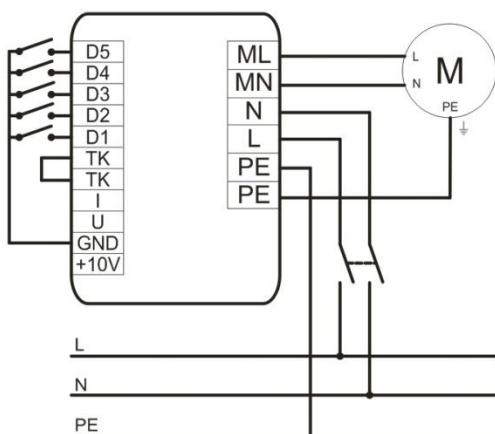
Řídící napětí 0 až 10 VDC (zapojení s termokontaktem motoru)
